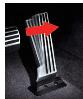
図4 アクセルペダル（反力発生機構付き）
