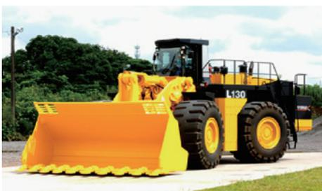
写真1 ハイブリッド式大型ホイールローダ外観
