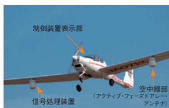
写真3 状況認知装置の搭載状態
