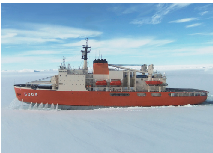
写真 散水装置を活用してラミング砕氷を行う「しらせ」
