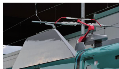
写真 2 低騒音パンタグラフと遮音板
