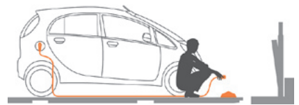
図 搬器上のコンセントに差し込む様子
