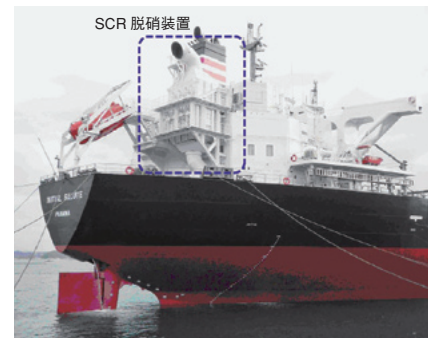
写真1 SCRシステムを搭載した石炭運搬船“INITIAL SALUTE”
