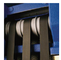
図3 主索 (フラットロープ) フラットロープとは銅製のワイヤーをウレタン樹脂でコーティングした平型ロープである
