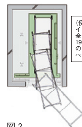
図2 フルオープンドア (戸全開でかご側面が出口側からフラットになるため、かご内の突起物を気にせずに乗降可能)
