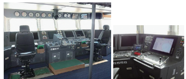
図3 操舵室コンソール(右写真:自動定点保持装置)
