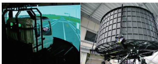
図2 モーションベース上の実車キャビンと円筒型のスクリーン
