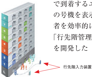
図1 行先階管理システム (近接階の利用者を同一のエレベータへ誘導)
