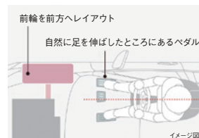
図4 人間に正対したペダル配置
