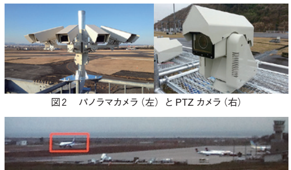
図3 物体認識機能による映像上の航空機的位置情報支援表示
