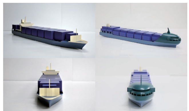
図2 風洞実験用模型(左:従来船型、右:球状船首ブリッジ型)
