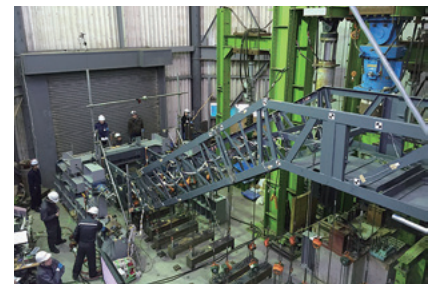
図1 エスカレータトラス圧縮実験（トラスを上部横から見た様子）
