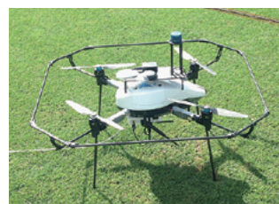
図5 無人機と機体動態監視システム 記事・図提供:(株)ウェザーニューズ
