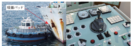
図3 新型のタグボート船型(左)と操船装置(右)
