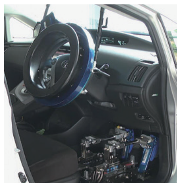
図1 実車搭載状態の操作ロボット
