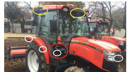
図3 安全装備(赤:レーザセンサ 白:超音波センサ 黄:アラウンドビューカメラ)
