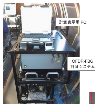
図1 計測機器機内搭載状況
