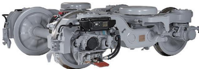
写真 2 片軸操舵台車 (左側：固定軸、右側：操舵軸)
