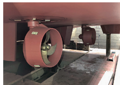
図3 電動式大口径のノズル付縦軸全旋回推進器
