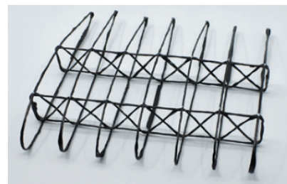
図3 CFRP の格子構造の例（小型無人機用モーフィング翼の骨組構造）
