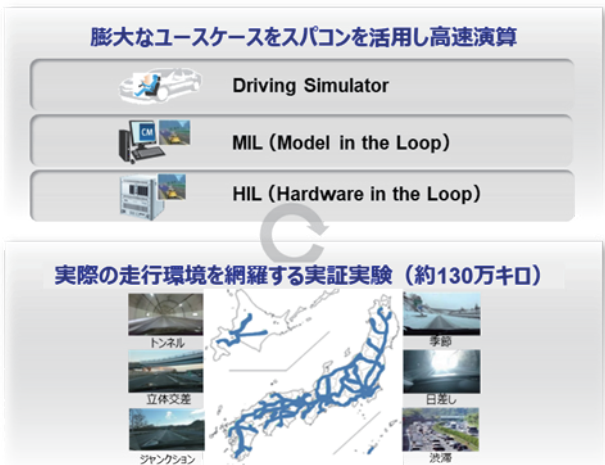
図 3 安全性・信頼性の確立に向けた開発プロセス
