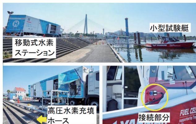
図3 移動式水素ステーションによる高圧水素充填
