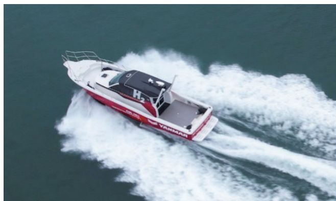
図1 水素燃料電池システムを搭載した小型試験艇の外観
