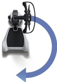
図3 その場旋回可能な操舵特性
