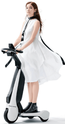
図1 立ち乗りタイプの三輪電動モビリティ
