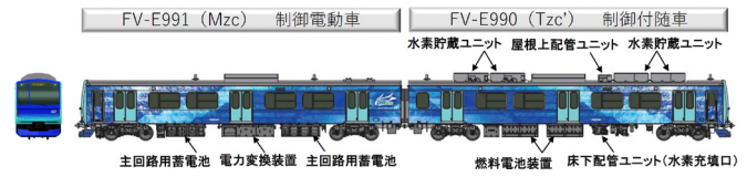
図2 燃料電池ハイブリッドシステムの概要
