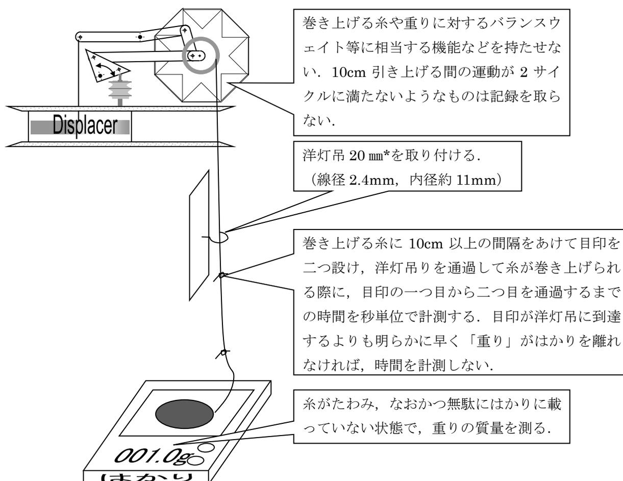
アピールの後、動作実演は原則 1 回行います。物体の引き上げを競う項目では、10cm を超えて物体を垂直に引き上げる時の所要時間と物体の質量を測ります。会場で用意される計測方法は上記の図のような方法を予定しております。引き上げる物体の質量は、0.5g 以上を 0.1g 刻みで計測します。200g を超える場合は事前に相談してください。また移動させる所要時間の計測は 1 秒を最小単位とし、一秒未満の端数は切り上げます。熱源については後述します。
