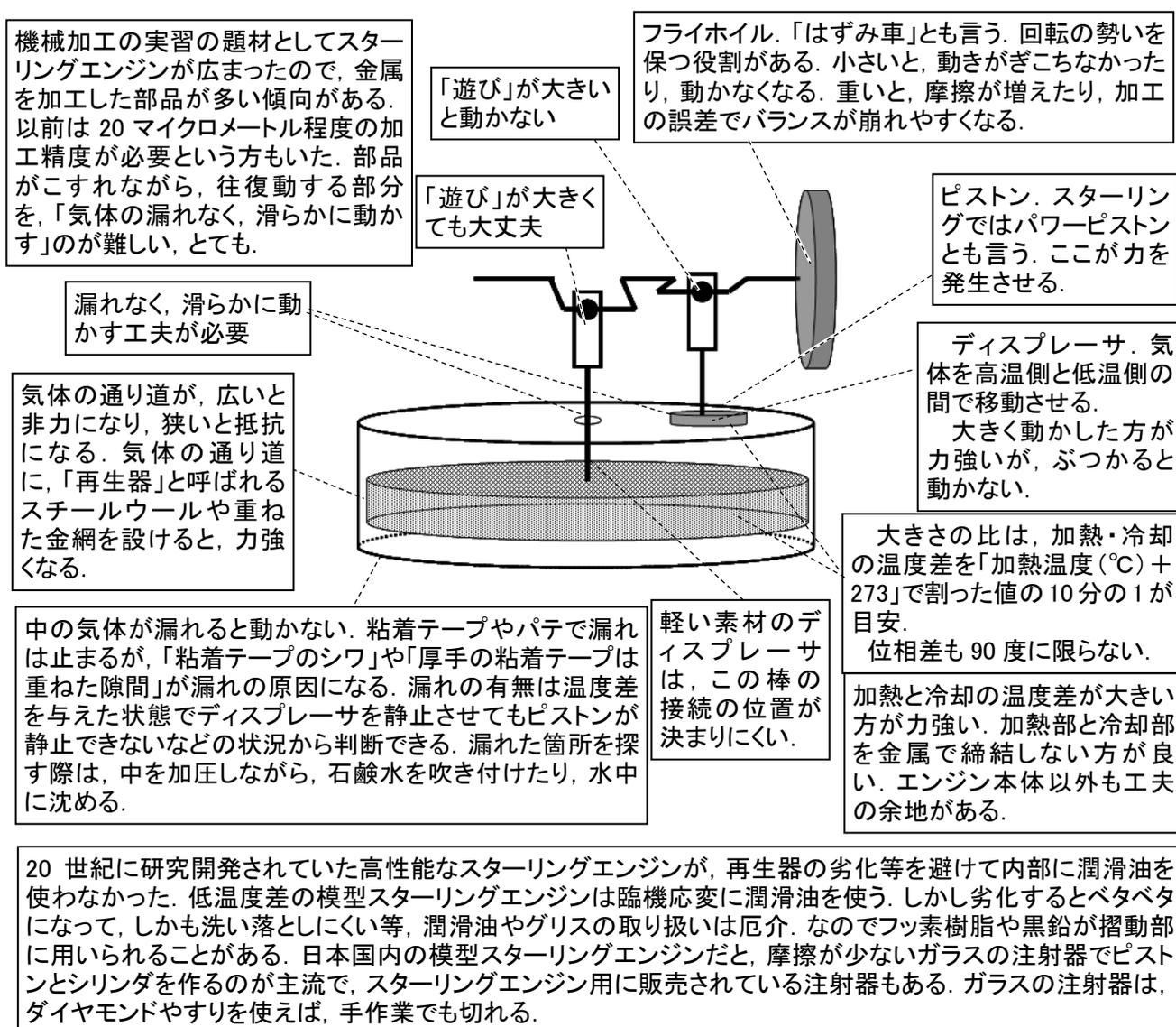
ちなみに平べったい密閉容器の上面と下面を加熱・冷却する構造は、作り易いのですが、理論的な限界に比べて桁違いに非力です。
