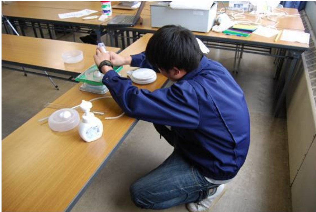
図5 行程容積確認のための計測
