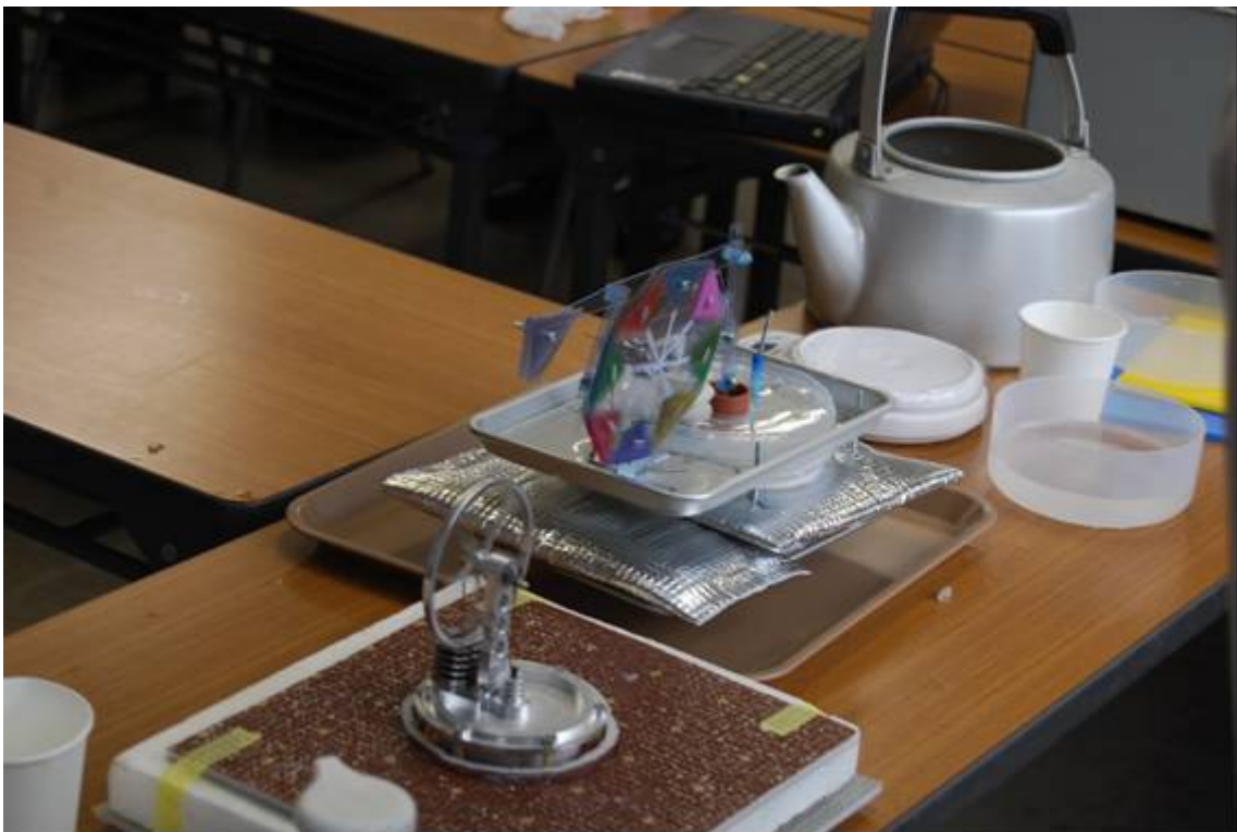
図 24 二つのスターリングエンジンが同時に動作する様子で、大平氏のスターリングエンジンは下部の放熱を抑制する工夫があり、上面は水で冷やしている。
