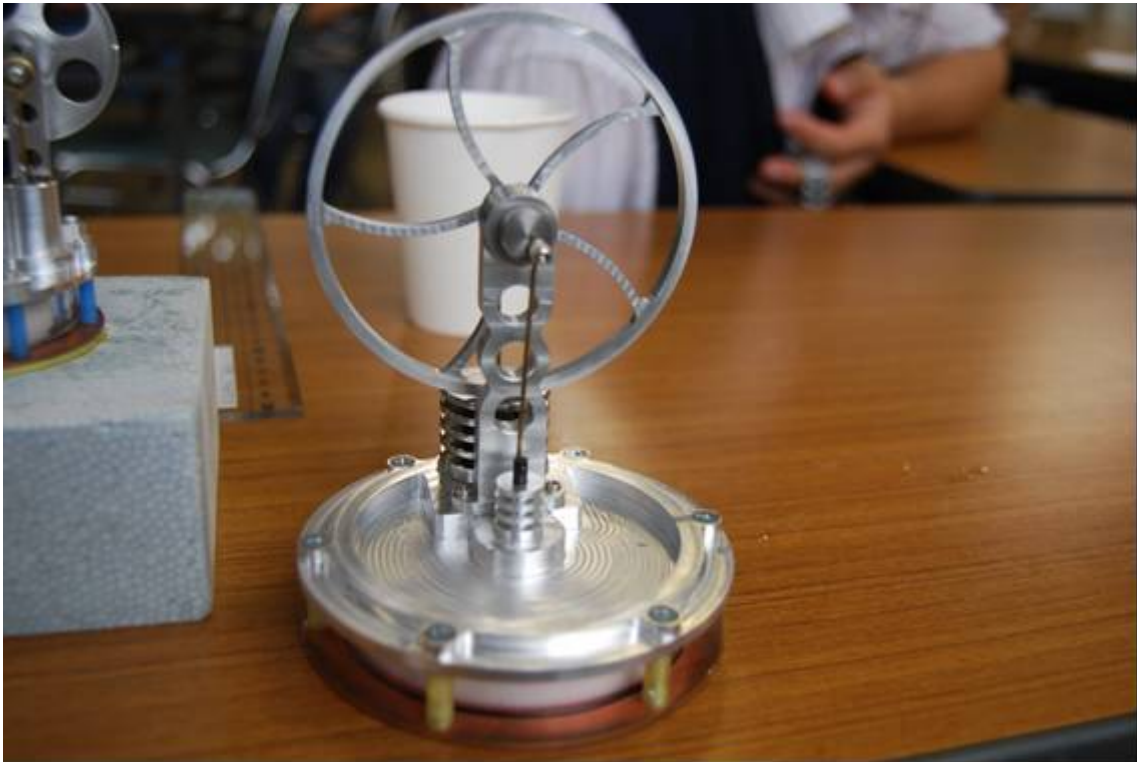
図 21 毛利製作所・久留米工大コラボチームの作品であり，43分弱動作し続けて競技会で優勝したキネマティックタイプのスターリングエンジン
