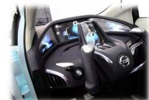
ジョイスティック型の操作機構
